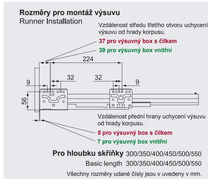
Rozměry bočnice s výsuvem
