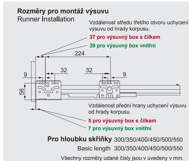
Rozměry bočnice s výsuvem
