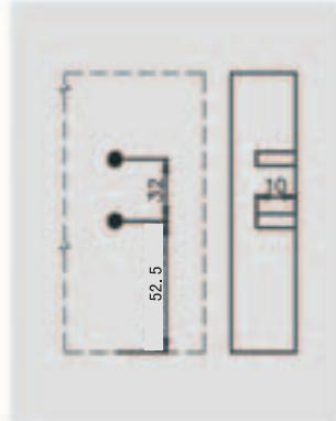
**Rozměry pro montáž držáku zadního panelu**
