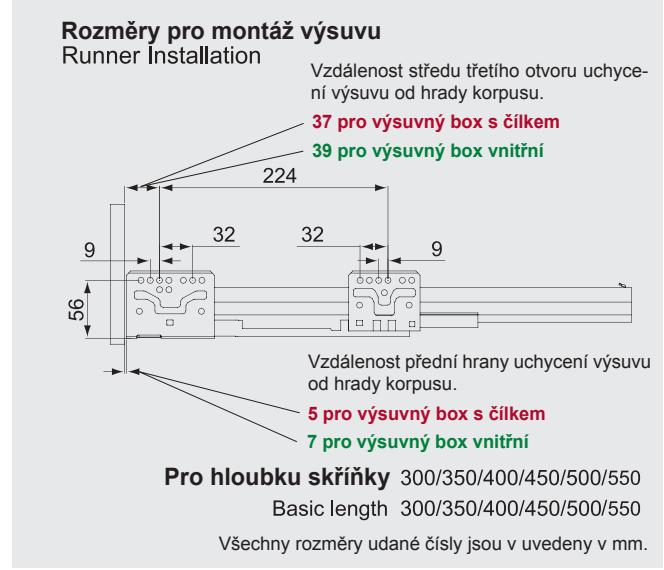
**Rozměry bočnice s výsuvem**
